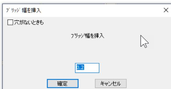
ブリッジの幅を設定し、OKをクリックし、グラフィック画面上でクリックし、パーツを横切る水平線または垂直線を描きます：
