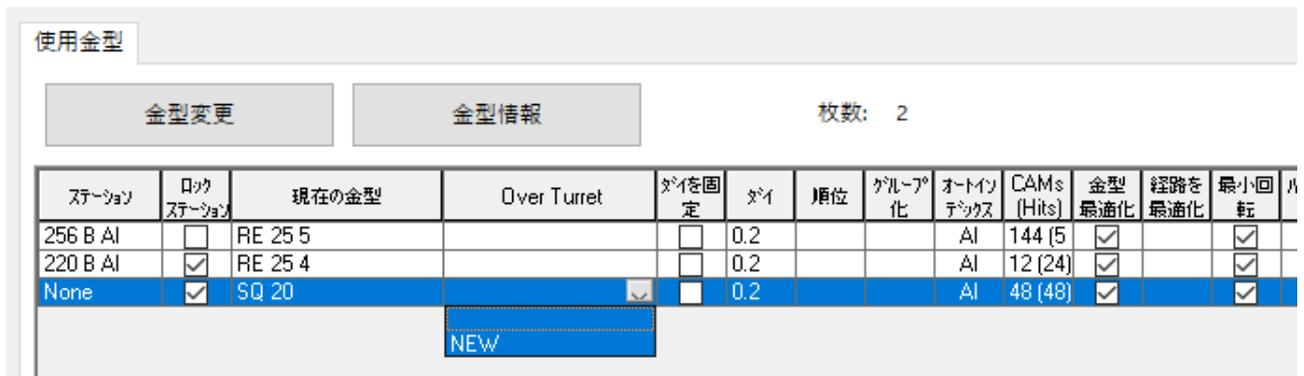
SQ 20ツールをステーション220に配置するには、ドロップダウンリストから手動でこのステーションを選択し、Over Turretの欄にNEWを設定します:
